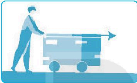
a) Lực của người đẩy thùng hàng với tỉ xích 1 cm ứng với 10 N
