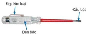
Hình 12.6. Cấu tạo của bút thử điện
