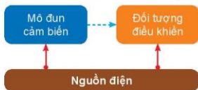
Hình 16.3. Sơ đồ khối của một mạch điện điều khiển sử dụng mô đun cảm biến
