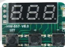
Hình 16.8. Màn hình hiển thị số và các nút cài đặt trên mô đun cảm biến nhiệt độ
